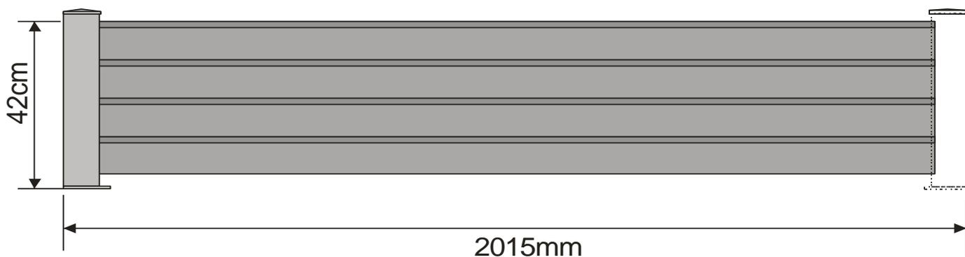
**Les poteaux permettent de poursuivre la travée avec un angle de 90°**
