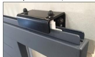
Ajuster le réglage en hauteur afin que le portail coulisse sans "points de force" durant toute l'ouverture / fermeture puis serrer les fixations. Ajuster également le réglage latéral (patin de glissement) afin que le portail soit bien d'aplomb puis serrer. Placer les caches écrous ④
