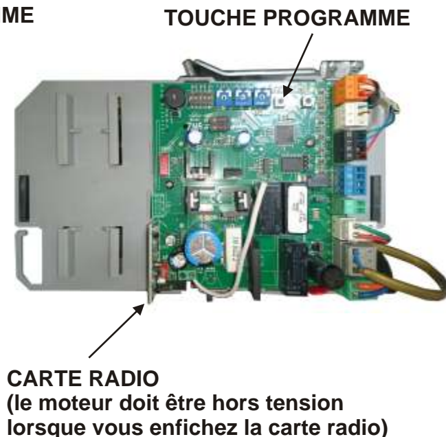
Platine électronique sans le cache
